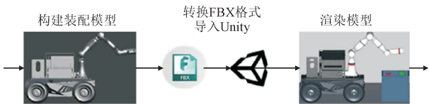
图 7 机械臂虚拟模型构建流程
